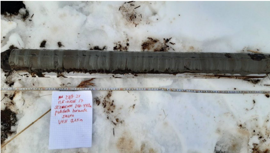
Kuva 50. Ylä-Hälvän (Uitonlahden) havaintopaikan 17 sedimenttinäyte 340-440 cm 28.03.2024.
