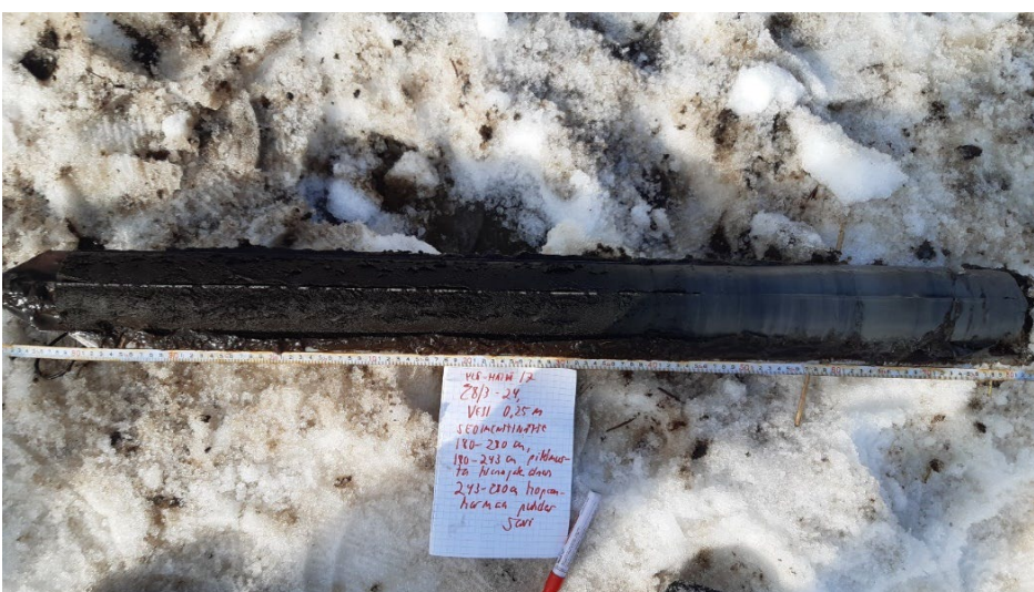
Kuva 49. Ylä-Hälvän (Uitonlahden) havaintopaikan 17 sedimenttinäyte 180-280 cm 28.03.2024.
