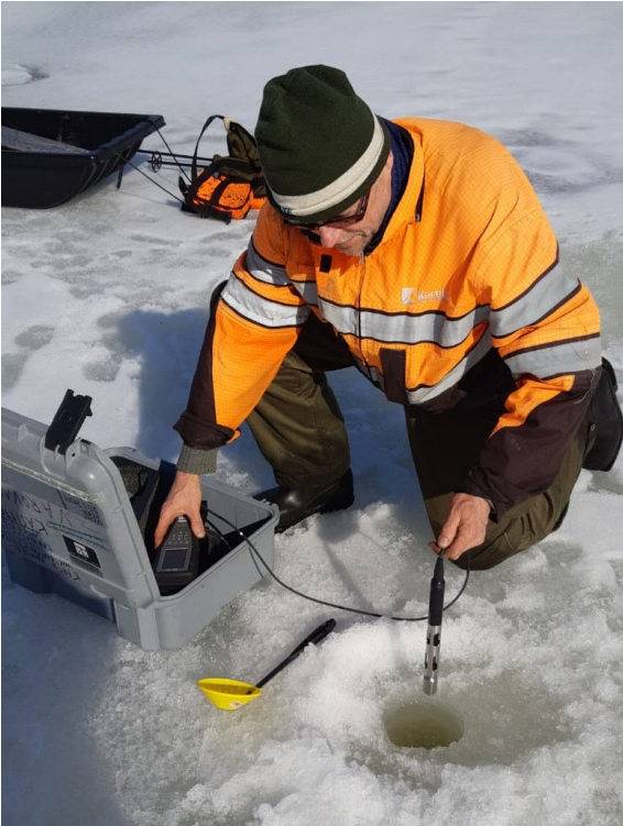
Kuva 9. Tarmo Tossavainen mittaa Ylä-Hälvän veden happipitoisuutta YSI Pro ODO-happikentämittarilla 28.03.2024. Kuva: Tarmo Kosonen.
