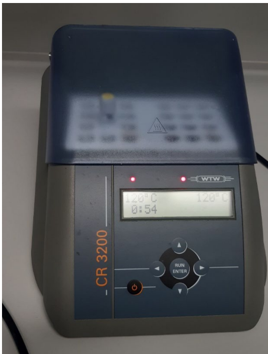
Kuvat 15 ja 16. Veden kokonaisfosforin ja -tyypin pitoisuuden mittauksessa käytettävä saksalaisvalmisteinen termoreaktori, WTW CR 3200 ja vedenlaadun mittauksessa kevättalvella 2024 käytetty saksalaisvalmisteinen filterifotometri WTW S 12.
