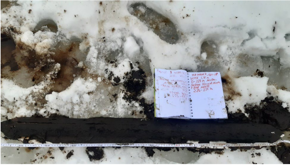
Kuva 38. Ylä-Hälvän havaintopaikan 7 sedimenttinäyte 238-338 cm 26.02.2024.
