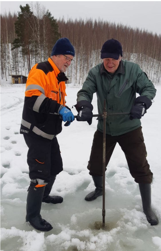
Kuva 10. Tarmo Kosonen (vas.) ja Reijo Jantunen ottavat laippakairalla sedimenttinäytteen Ylä-Hälvästä maaliskuussa 2024.
