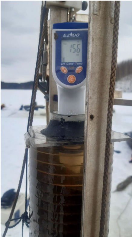
Kuvat 13 ja 14. Ylä-Hälvän pintasedimentin hapetus-pelkistysasteen (redox-potentiaalin) mitaus (vas.) ja pohjasedimenttinäyte viipaloivassa Limnos-näytteenottimessa 26.03.2024.
