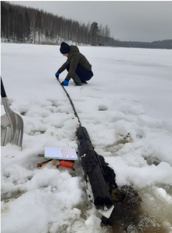
Kuva 11. Karelia-ammattikorkeakoulun opiskelija Joni Miettinen ja Ylä-Hälvästä laippakairalla juuri otettu sedimenttinäyte helmikuussa 2024.
