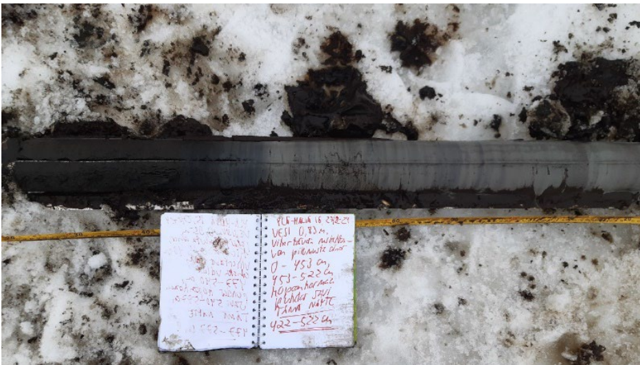
Kuva 47. Ylä-Hälvän havaintopaikan 16 sedimenttinäyte 422-522 cm 27.02.2024.
