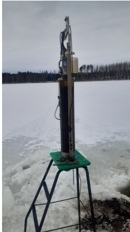
Kuvat 13 ja 14. Ylä-Hälvän pintasedimentin hapetus-pelkistysasteen (redox-potentiaalin) mitaus (vas.) ja pohjasedimenttinäyte viipaloivassa Limnos-näytteenottimessa 26.03.2024.
