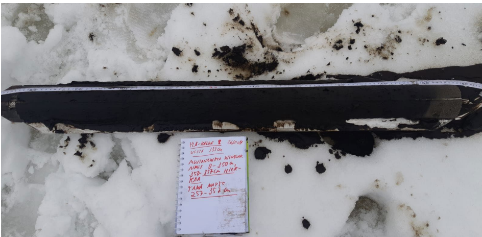
Kuva 39. Ylä-Hälvän havaintopaikan 8 sedimenttinäyte 257-357 cm 26.02.2024.
