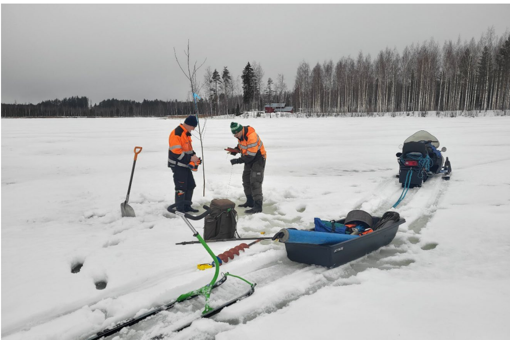
Tarmo Kosonen (vas.) ja Tarmo Tossavainen luotaavat vesisyvyyden sedimenttikairausta varten maaliskuussa 2024. Kuva: Reijo Jantunen
