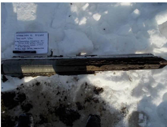
Kuva 34. Kuonanjärven kaakkoisella ulapalla sijaitsevan havaintopaikan 11 sedimenttinäyte 100 – 200 cm 15.03.2018. Näytteenottimena turvekaira.
