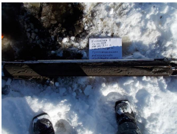
Kuva 55. Kuonanjärven luoteiskolkassa sijaitsevan havaintopaikan 8 sedimenttinäyte 100 – 200 cm 26.03.2018. Näytteenottimena turvekaira.
