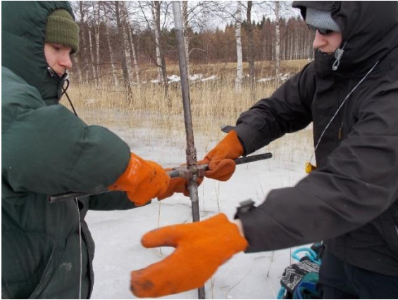
Kuva 13. Karelia-ammattikorkeakoulun opiskelijat Atte Varis (vas.) ja Lassi Puurunen ottavat järven sedimenttinäytettä turvekairalla.
