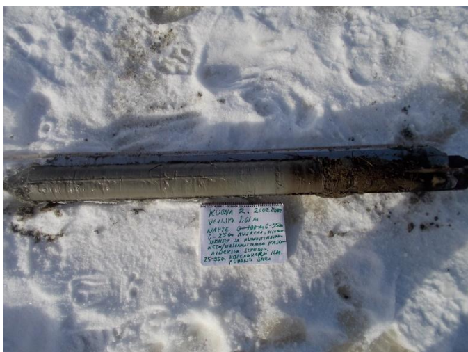
Kuva 26. Kuonanjärven kaakkoiskolkassa sijaitsevan havaintopaikan 2 sedimenttinäyte 0 – 95 cm 21.02.2018. Näytteenottimena turvekaira.
