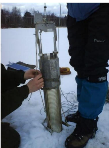
Kuva 15. Lyijypainoja kiinnitetään Limnos-sedimenttinoutimeen näytteenottoa varten.
