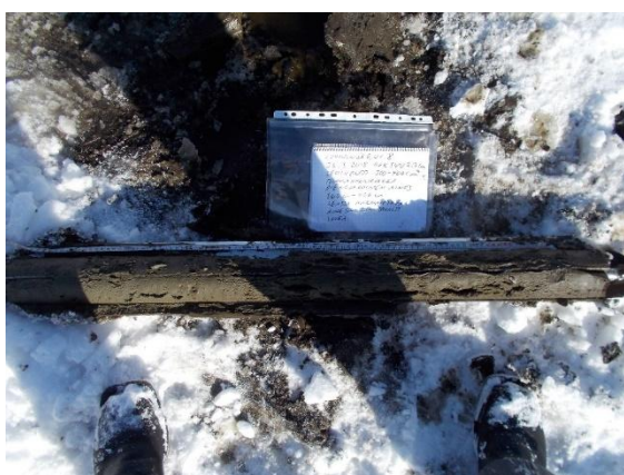
Kuva 57. Kuonanjärven luoteiskolkassa sijaitsevan havaintopaikan 8 sedimenttinäyte 300 – 400 cm 26.03.2018. Näytteenottimena turvekaira.
