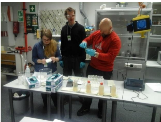
Kuva 22. Opiskelijat Riikka Mikkonen, Väinö Rintala ja Jani Viitamäki mittaavat Kuonanjärven vesinäytteiden liukoisten ravinteiden pitoisuuksia WTW S12A -filtterifotometrillä huhtikuussa 2018 Karelia-ammattikorkeakoulun laboratoriossa Joensuussa.
