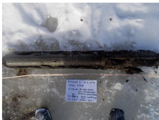
Kuva 24. Kuonanjärven kaakkoiskolkassa aivan Kuonanjoen edustalla sijaitsevan havaintopaikan 1 sedimenttinäyte 0 - 100 cm 21.02.2018. Näytteenottimena turvekaira.
