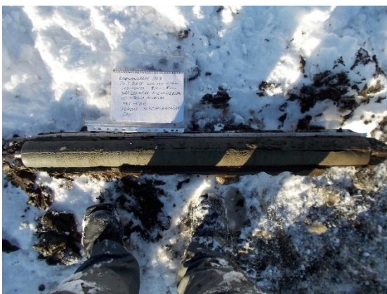
Kuva 46. Luoteisella Kuonanjärvellä Kokkosaaren eteläpuolella sijaitsevan havaintopaikan 003 sedimenttinäyte 400 - 500 cm 26.03.2018. Näytteenottimena turvekaira. Havaintopaikka on myös ympäristöhallinnon intensiivinen vedenlaadun seuranta-asema.
