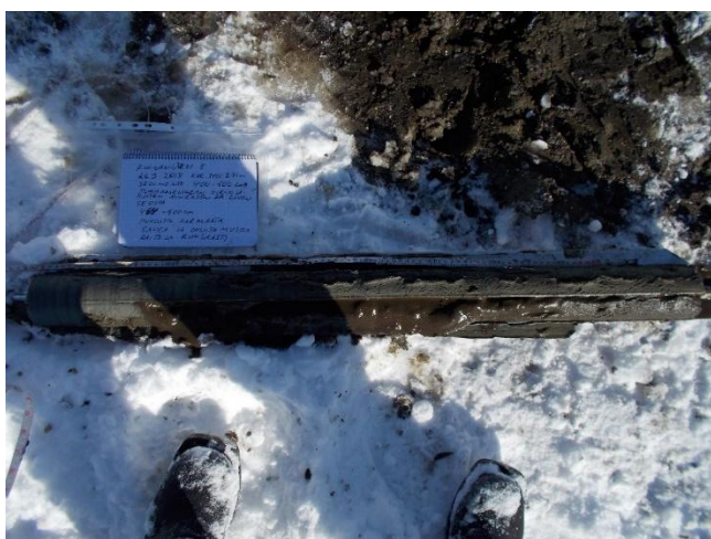
Kuva 59. Kuonanjärven luoteiskolkassa sijaitsevan havaintopaikan 8 sedimenttinäyte 400 – 500 cm 26.03.2018. Näytteenottimena turvekaira.
