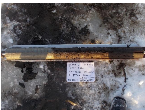
Kuva 29. Kuonanjärven kaakkoisella ulapalla sijaitsevan havaintopaikan 6 sedimenttinäyte 100 - 187 cm 21.02.2018. Näytteenottimena turvekaira.
