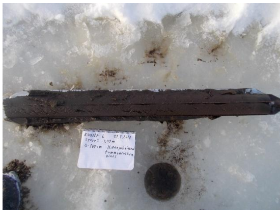
Kuva 28. Kuonanjärven kaakkoisella ulapalla sijaitsevan havaintopaikan 6 sedimenttinäyte 0 - 100 cm 21.02.2018. Näytteenottimena turvekaira.
