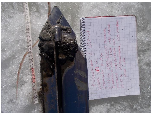
Kuva 58. Kuonanjärven kaakkoiskolkassa sijaitsevan havaintopaikan 3 sedimenttinäyte 0 – 15 cm 13.04.2018. Näytteenottimena turvekaira.
