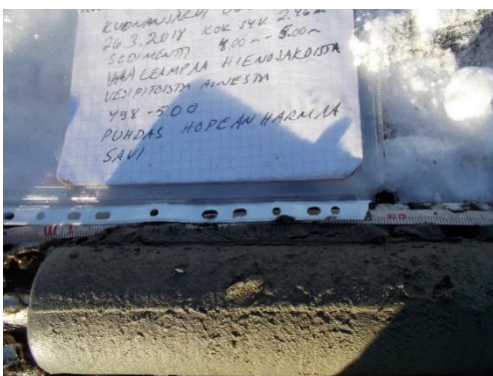
Kuva 47. Lähikuva Luoteisella Kuonanjärvellä Kokkosaaren eteläpuolella sijaitsevan havaintopaikan 003 sedimenttinäytteestä 400 - 500 cm 26.03.2018. Näytteenottimena turvekaira. Havaintopaikka on myös ympäristöhallinnon intensiivinen vedenlaadun seuranta-asema.
