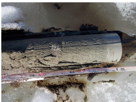
Kuva 50. Lähikuva Keskisellä Kuonanjärvellä Kokkosaaren itäpuolella sijaitsevan havaintopaikan 10 sedimenttinäytteestä 100 – 200 cm 18.04.2018. Näytteenottimena turvekaira.
