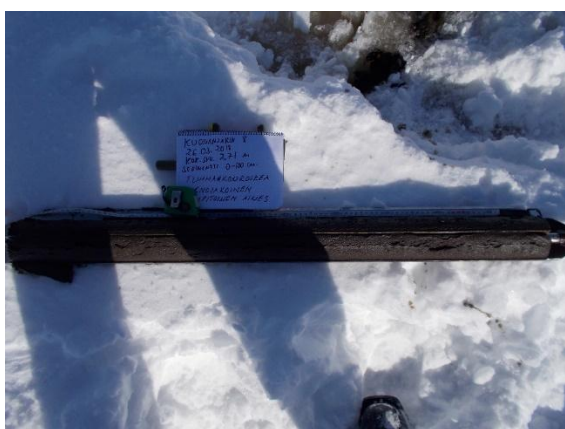
Kuva 54. Kuonanjärven luoteiskolkassa sijaitsevan havaintopaikan 8 sedimenttinäyte 0 - 100 cm 26.03.2018. Näytteenottimena turvekaira.
