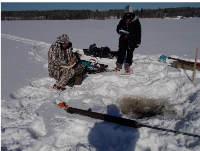
Kuva 13. Karelia-ammattikorkeakoulun opiskelijat Atte Varis (vas.) ja Lassi Puurunen ottavat järven sedimenttinäytettä turvekairalla.
