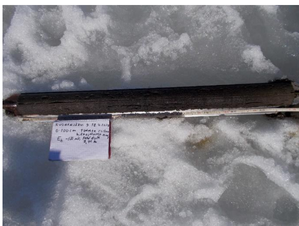
Kuva 51. Pohjoisella Kuonanjärvellä Kokkosaaren pohjoispuolella sijaitsevan havaintopaikan 9 sedimenttinäyte 0 – 100 cm 18.04.2018. Näytteenottimena turvekaira.
