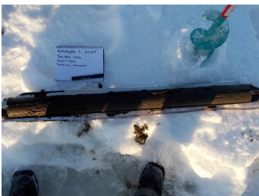
Kuva 39. Kaakkoisella Kuonanjärvellä Riikolahdessa sijaitsevan havaintopaikan 5 sedimenttinäyte 0 - 100 cm 15.03.2018. Näytteenottimena turvekaira.
