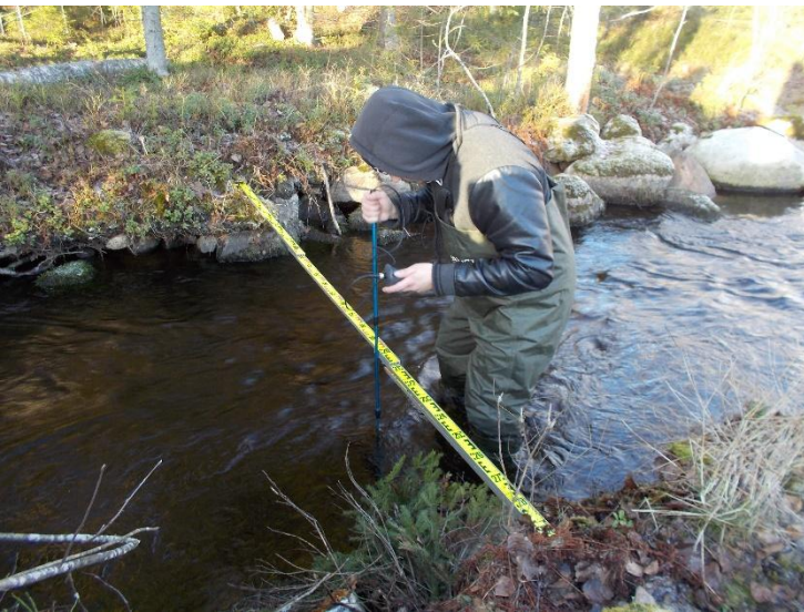
Kuva 23b. Insinööriopiskelija Rico-Petteri Mutanen mittaa Vehkaojan virtaamaa havaintopaikalla 018 22.11.2018.
