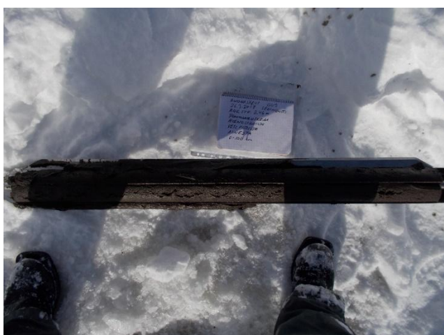
Kuva 42. Luoteisella Kuonanjärvellä Kokkosaaren eteläpuolella sijaitsevan havaintopaikan 003 sedimenttinäyte 0 – 100 cm 26.03.2018. Näytteenottimena turvekaira. Havaintopaikka on myös ympäristöhallinnon intensiivinen vedenlaadun seuranta-asema.
