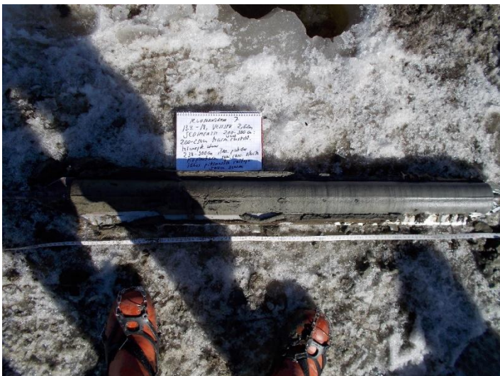
Kuva 37. Keskisellä Kuonanjärvellä sijaitsevan havaintopaikan 7 sedimenttinäyte 200 - 300 cm 13.04.2018. Näytteenottimena turvekaira.
