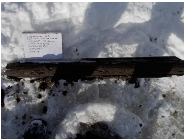
Kuva 43. Luoteisella Kuonanjärvellä Kokkosaaressä sijaitsevan havaintopaikan 003 sedimenttinäyte 100 - 200 cm 26.03.2018. Näytteenottimena turvekaira. Havaintopaikka on myös ympäristöhallinnon intensiivinen vedenlaadun seuranta-asema.
