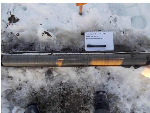
Kuva 41. Kaakkoisella Kuonanjärvellä Riikolahdessa sijaitsevan havaintopaikan 5 sedimenttinäyte 200 – 300 cm 15.03.2018. Näytteenottimena turvekaira.
