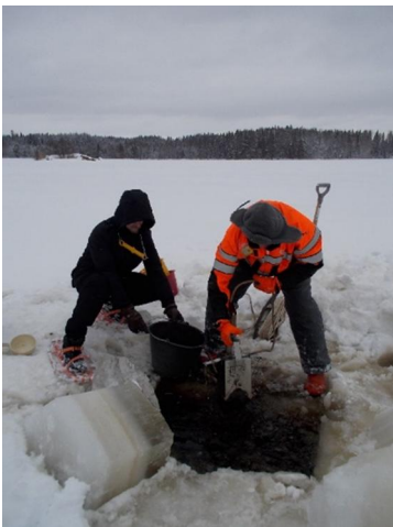
Kuva 17. Karelia-ammattikorkeakoulun opiskelija Jere Tiitta (vas.) ja Tarmo Tossavainen ovat juuri ottaneet järven pohjaeläinnäytteen Ekman-tyyppisellä näytteenottimella Kuonanjärven luoteiskolkassa huhtikuun alussa 2018. Kuva: Joanna Latoszek.
