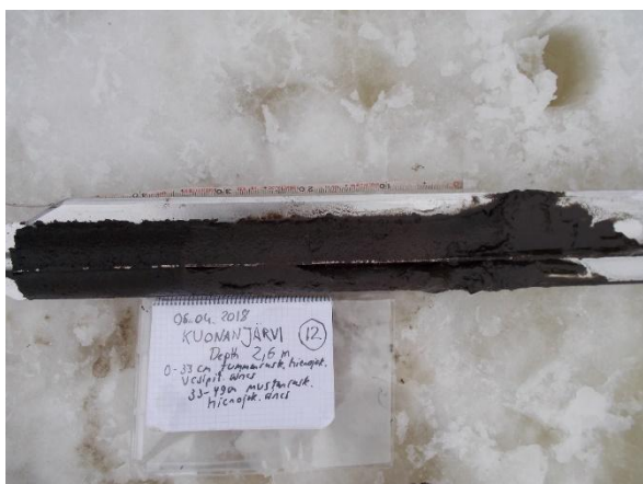
Kuva 27. Kuonanjärven kaakkoiskolkan ulapalla sijaitsevan havaintopaikan 12 sedimenttinäyte 0 – 49 cm 06.04.2018. Näytteenottimena turvekaira.
