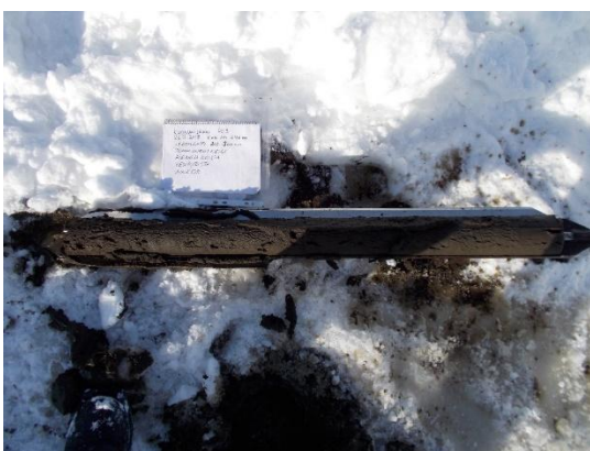
Kuva 44. Luoteisella Kuonanjärvellä Kokkosaaressä sijaitsevan havaintopaikan 003 sedimenttinäyte 200 - 300 cm 26.03.2018. Näytteenottimena turvekaira. Havaintopaikka on myös ympäristöhallinnon intensiivinen vedenlaadun seuranta-asema.
