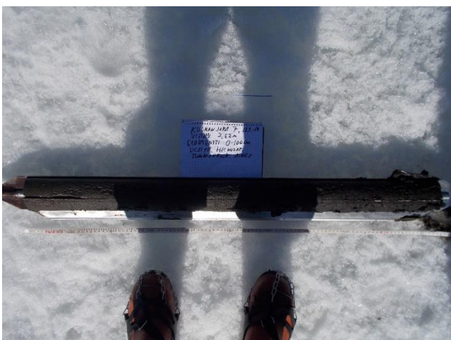
Kuva 36. Keskisellä Kuonanjärvellä sijaitsevan havaintopaikan 7 sedimenttinäyte 0 – 100 cm 13.04.2018. Näytteenottimena turvekaira.
