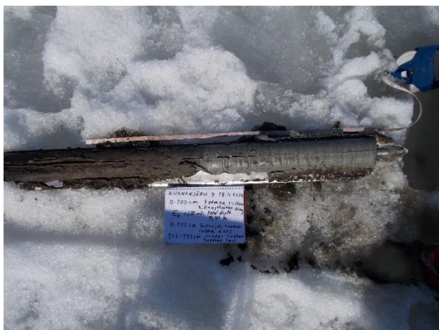
Kuva 52. Pohjoisella Kuonanjärvellä Kokkosaaren pohjoispuolella sijaitsevan havaintopaikan 9 sedimenttinäyte 77 - 177 cm 18.04.2018. Näytteenottimena turvekaira.
