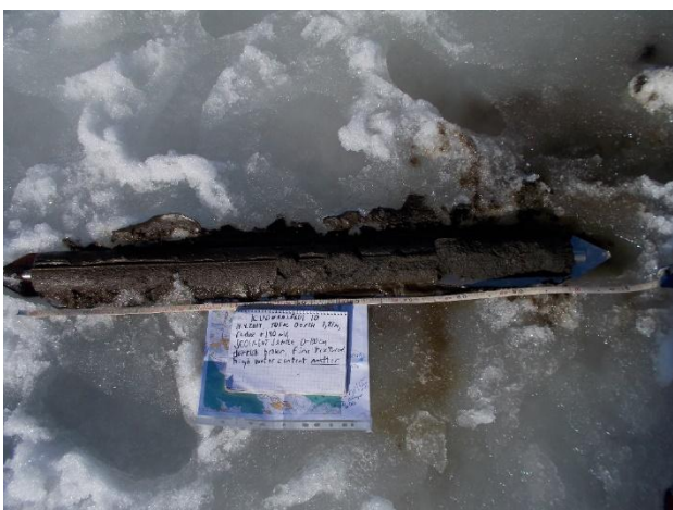
Kuva 48. Keskisellä Kuonanjärvellä Kokkosaaren itäpuolella sijaitsevan havaintopaikan 10 sedimenttinäyte 0 - 100 cm 18.04.2018. Näytteenottimena turvekaira.
