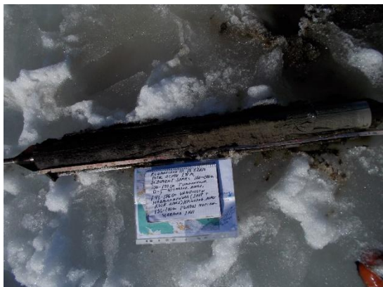
Kuva 49. Keskisellä Kuonanjärvellä Kokkosaaren itäpuolella sijaitsevan havaintopaikan 10 sedimenttinäyte 100 – 200 cm 18.04.2018. Näytteenottimena turvekaira.
