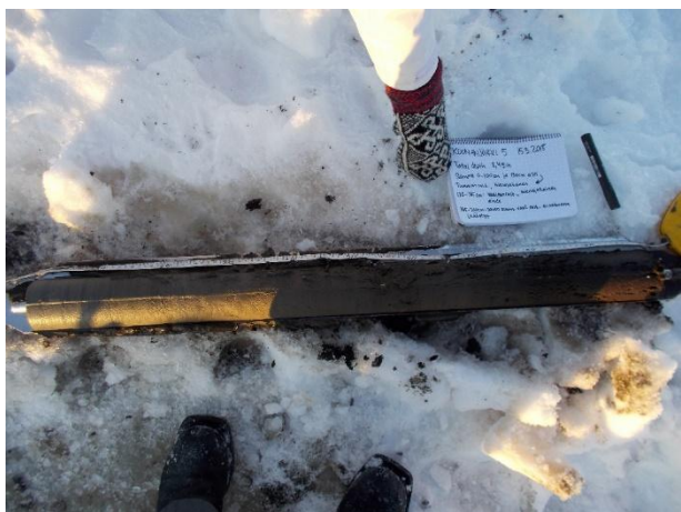
Kuva 40. Kaakkoisella Kuonanjärvellä Riikolahdessa sijaitsevan havaintopaikan 5 sedimenttinäyte 100 – 200 cm 15.03.2018. Näytteenottimena turvekaira.
