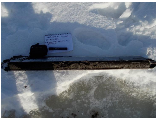
Kuva 33. Kuonanjärven kaakkoisella ulapalla sijaitsevan havaintopaikan 11 sedimenttinäyte 0 – 100 cm 15.03.2018. Näytteenottimena turvekaira.
