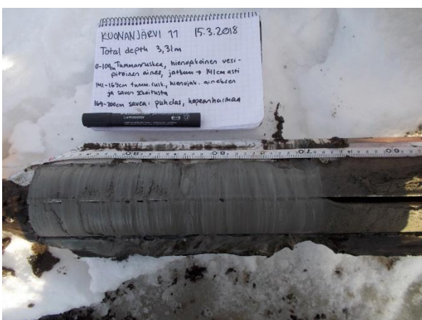
Kuva 35. Lähikuva Kuonanjärven kaakkoisella ulapalla sijaitsevan havaintopaikan 11 sedimenttinäytteestä 100 – 200 cm 15.03.2018. Näytteenottimena turvekaira.
