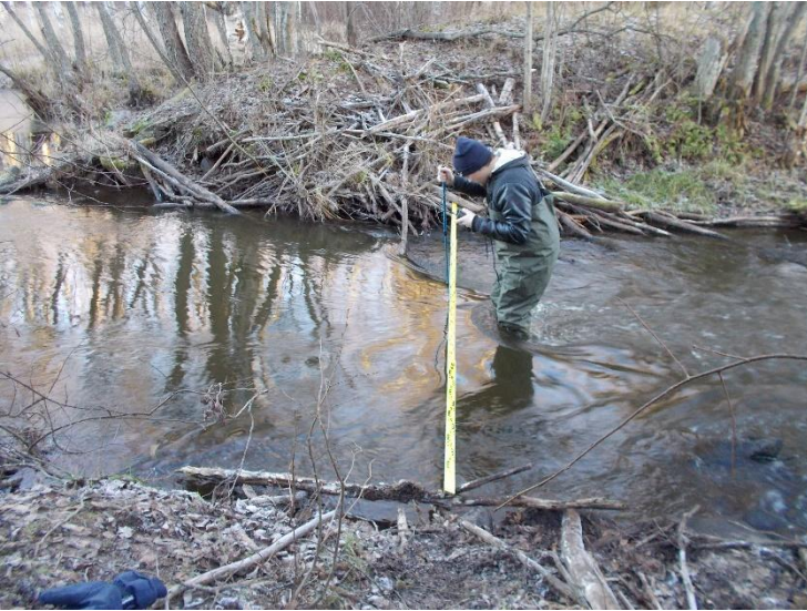
Kuva 23a. Insinööriopiskelija Rico-Petteri Mutanen mittaa Kuonanjoen virtaamaa havaintopaikalla 185 22.11.2018.
