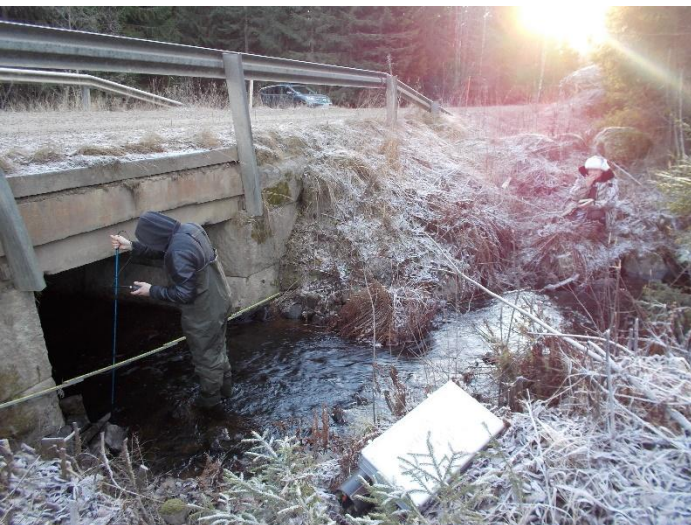
Kuva 23c. Insinööriopiskelija Rico-Petteri Mutanen mittaa Tenhunjoen virtaamaa havaintopaikalla 169 22.11.2018. Insinööriopiskelija Minna Kutvonen kirjaa mittauslukemia.
