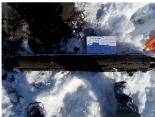
Kuva 56. Kuonanjärven luoteiskolkassa sijaitsevan havaintopaikan 8 sedimenttinäyte 200 – 300 cm 26.03.2018. Näytteenottimena turvekaira.
